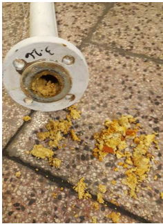
Dopravní potrubí zalepené a zkorodovaný uzávěr – následek zpětného tahu
