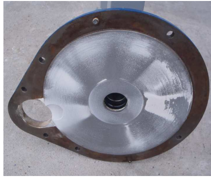
Abrazí poškozené víko rotačního podavače
