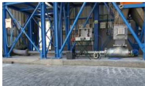
Nový ejektorový podavač s měřicí aparaturou
