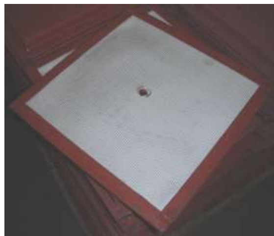
Provzdušňovací skříňka s fluidizační tkaninou
