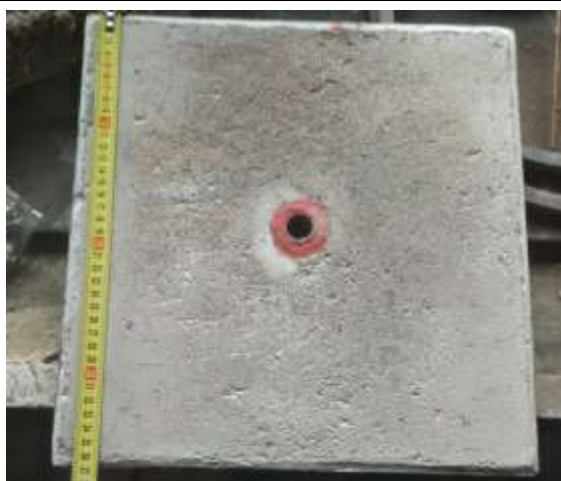
Provzdušňovací skříň s porézní keramikou
