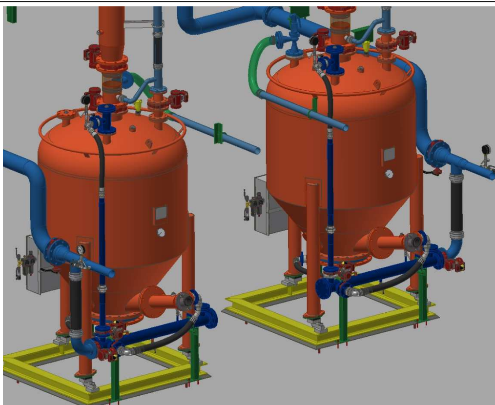
Příklad uvolnění vzduchového, plicního a odprašovacího potrubí podavače PKRH
