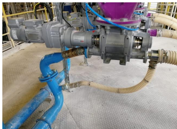
Rotační podavač s profukovanými kapsami a postupným navyšováním dopravní rychlosti
