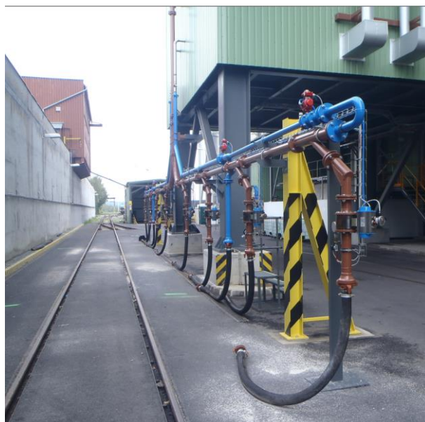
Pohled na poloautomatickou vykládací stanici vagonů Raj pro současnou vykládku dvou vagonů (jedna nádoba z každého vagonu)
