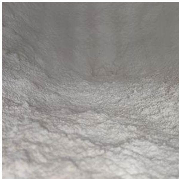
Odprašky CaCl 2 shromážděné ve výsypce filtru
