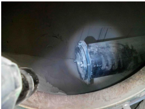
Směšovač komorového podavače PKRH bez opotřebení
