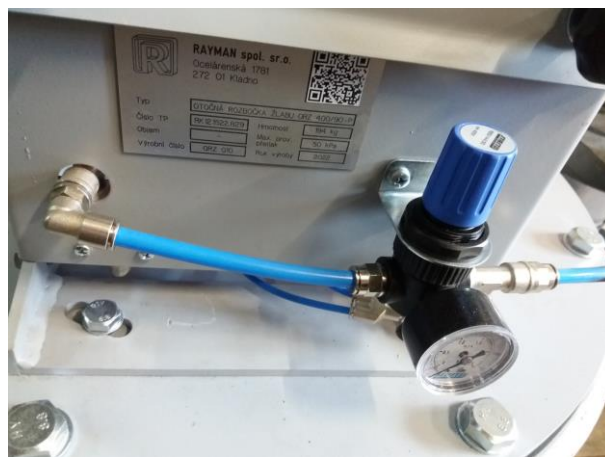
Upravené uložení pneumatického ovládání
