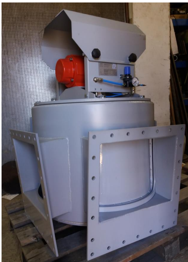
Žlabová rozbočka ORZ se zákrytem pneupohonu
