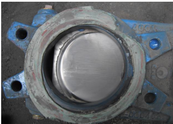
Otěrem poškozené standardní nožové šoupátko
