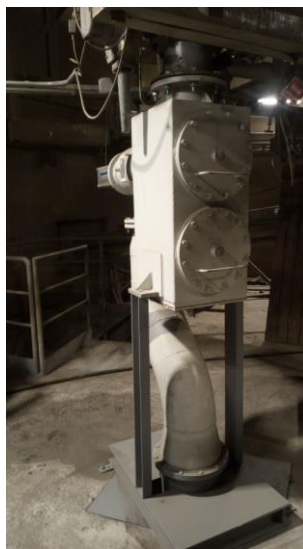
Zadní pohled na fluidizační/segregační komoru a skluzové potrubí
