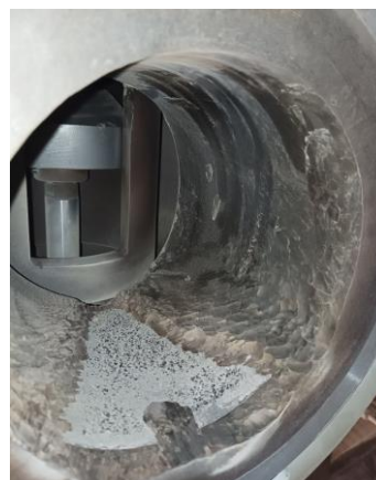
Opotřebená vnitřní trubka výstupního hrdla regulačního vykladače s cestivou densitovou vložkou
