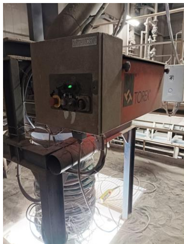
Původní plnicí hubice a závěje prachu v jejím okolí
