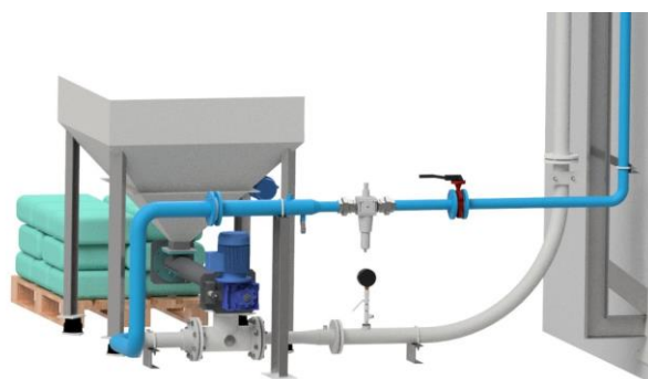
Podávací zařízení – násypka sody, dávkovací šnek a ejektorový podavač
