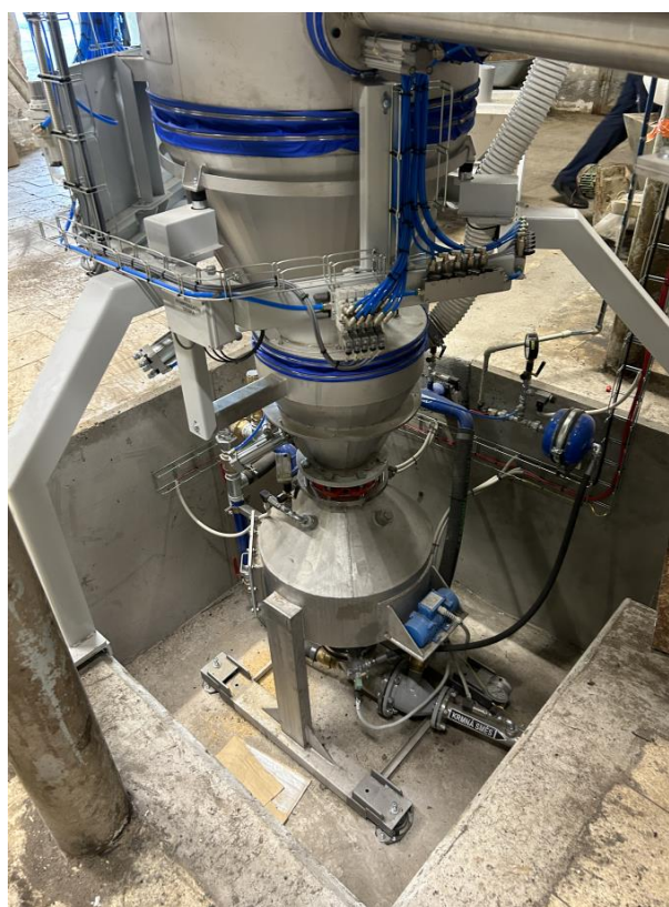
Komorový podavač PKM 200 (nerezové provedení) pro dopravu krmných směsí
